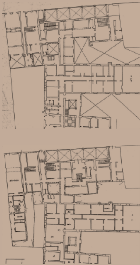
Figg. 5 e 6 - Piantine degli uffici risalenti rispettivamente a prima e dopo gli interventi del 1949: si notino la costruzione dello scalone d'ingresso, la risistemazione dei cortili, la creazione di nuovi ambienti
