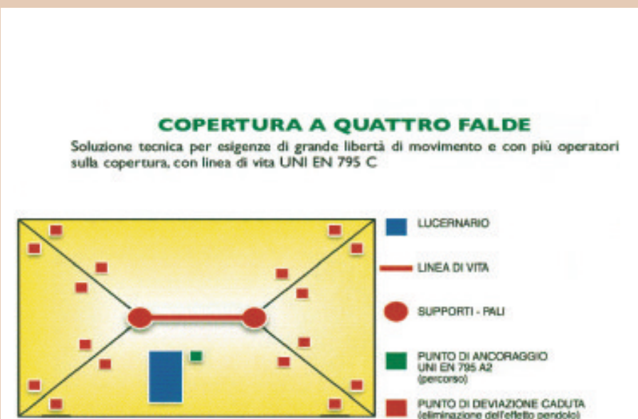
Fig. 3 - Disposizione di punti di ancoraggio e linea vita sulla copertura
