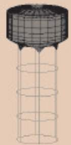
Fig. 13 - Geometria indeformata e "meshatura" adottata per schematizzare il serbatoio.
