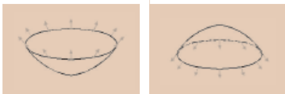
Fig. 8 - Membrana e cupola sottoposte a regime di puro sforzo normale.
