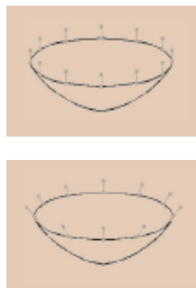
Fig. 9 - Sistema di vincoli esterni imposti alla membrana. Nel primo caso si ha un'alterazione dello stato di sollecitazione di puro sforzo normale, nel secondo caso viene mantenuto tale stato di sollecitazione.
