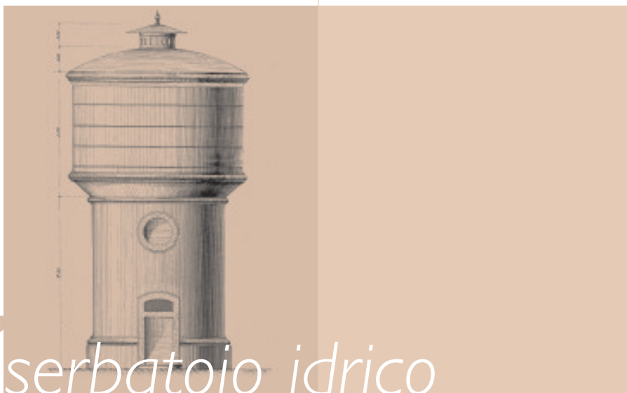
Fig. 1 - Tipica struttura per serbatoio pensile adottata dalle Ferrovie negli anni '30: prospetto.
