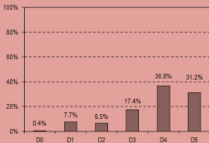
Fig. 19 - Distribuzione del livello di danno per gli edifici in muratura di pietrame.
