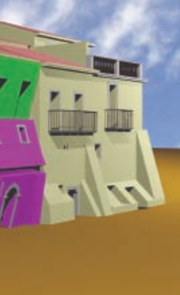
Fig. 2 - Aggregato e unità strutturali costituenti.
