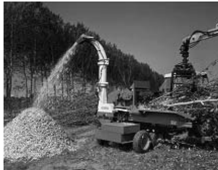
Foto 2 - Operazione di cippatura (fonte AIEL - Associazione Italiana Energia dal Legno)
