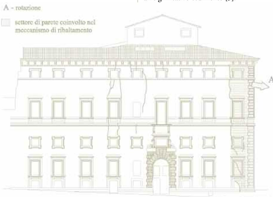
Figura 10. Settore della parete perimetrale Sud coinvolto nel meccanismo di ribaltamento.
