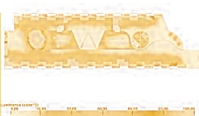
studio dei parametri termo-fisici, fotometrici e ottici di ogni superficie dello stand e oggetto esposto. In particolare la reazione alla luce dei diversi tessuti ha orientato le scelte sull'illuminazione di accento, mentre le risposte in termini di variazione dei parametri colorimetrici e fotometrici dell'ambiente e di distribuzione della luminanza sulle pareti e sugli oggetti hanno supportato le scelte per l'illuminazione di base (spazi e percorsi espositivi).
