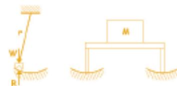
Fig. 1 - Principio di funzionamento del SFP
