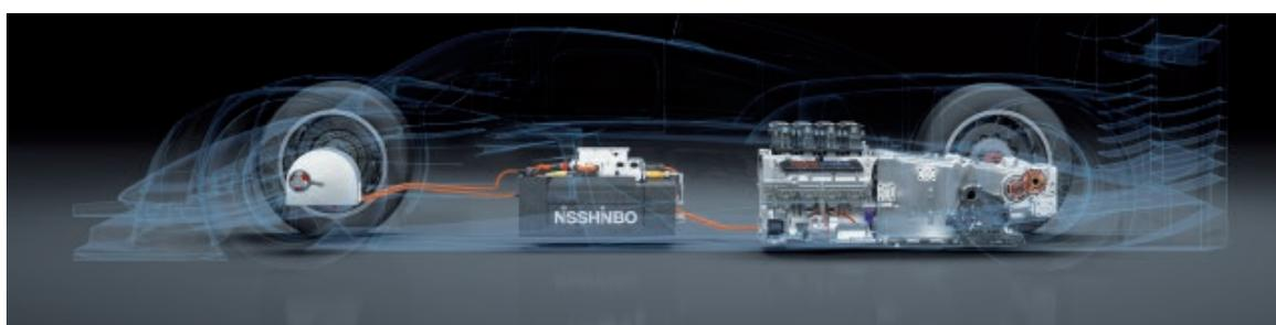
Disposizione del KERS e del supercondensatore.
