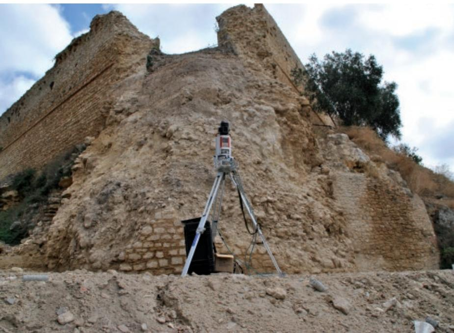
Foto 12 – Rilievo con strumento laser-scanner.
