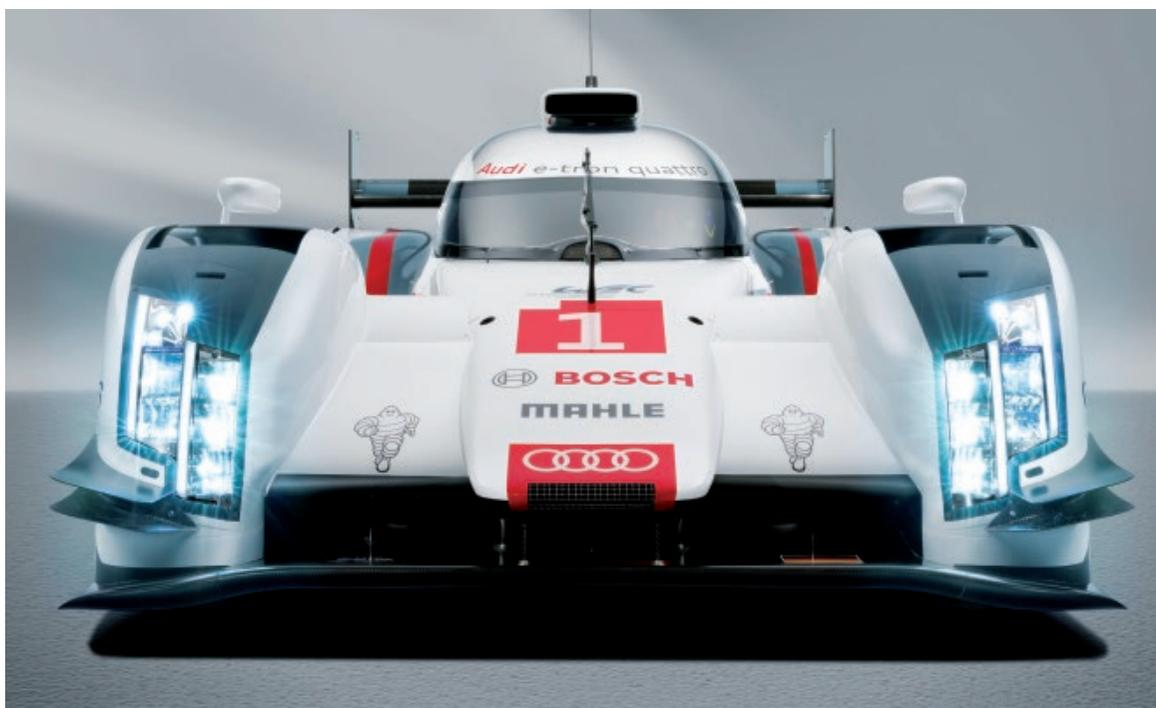
Profilo anteriore. Si notino le fessure realizzate sul pannello frontale per generare un miglior carico aerodinamico.
