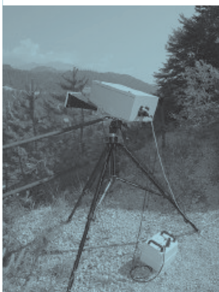
Fig.1 - Il radar interferometrico portatile IBIS, prodotto dalla IDS SpA, Pisa
