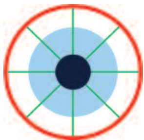
Fig. 46 - Pianta schematica della ciminiera. In evidenza le diverse parti che la compongono: la superficie vetrata (in rosso); il collegamento con il nucleo (in verde); la scala elicoidale (in celeste); l'ascensore cilindrico (in blu)
