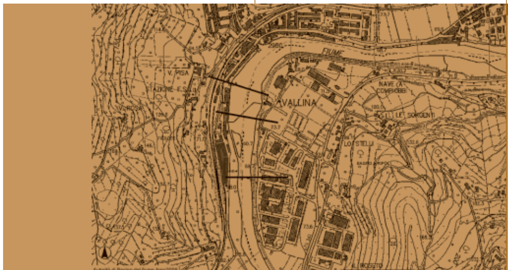
Fig. 37 – Pianta con sezioni dell'Autorità di Bacino in corrispondenza delle quali vi sono le indicazioni riguardanti le quote di allagamento [39]
