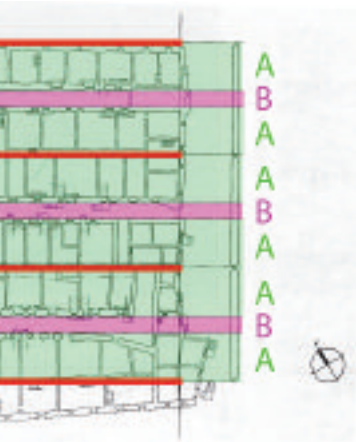
Fig. C.1 - Fasce distributive e individuazione setti murari.
