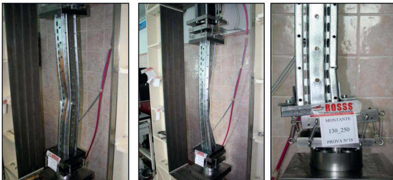
molla infinitamente rigida a compressione e una forza ammissibile di trazione molto ridotta; in questo modo nel momento in cui la base del provino si parzializza, durante un qualsiasi step di carico, le molle presenti nella parte in trazione si disattivano permettendo il sollevamento del profilo dalle piastre di alloggiamento.
