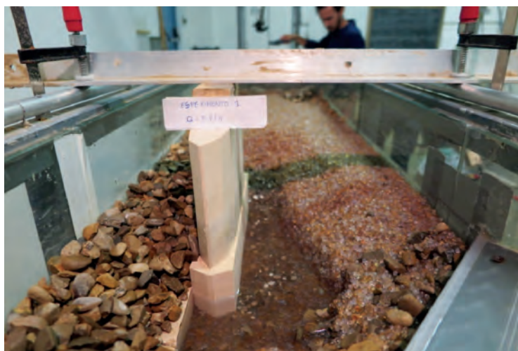
▲ Fig. 16A - Fotografia dello scavo - Pila 5 cm con Q = 5 l/s.
