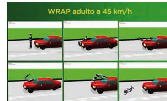
FIG. 4 Esempio di investimento tipo "wrap" di adulto a 45 km/h
