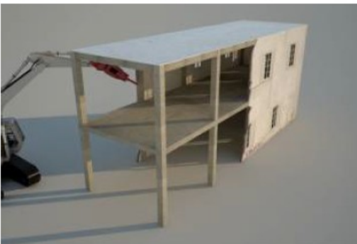
Demolizione muratura (messa a nudo telaio)
