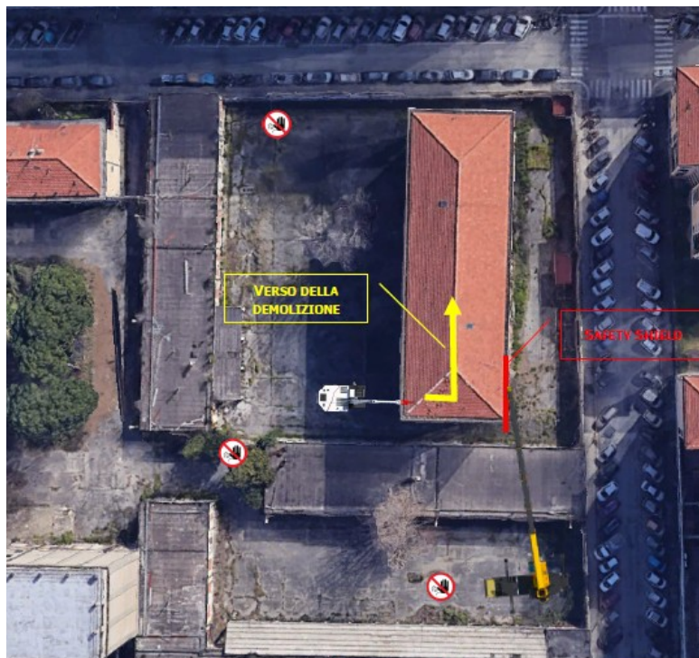
Disposizione mezzi durante la demolizione
