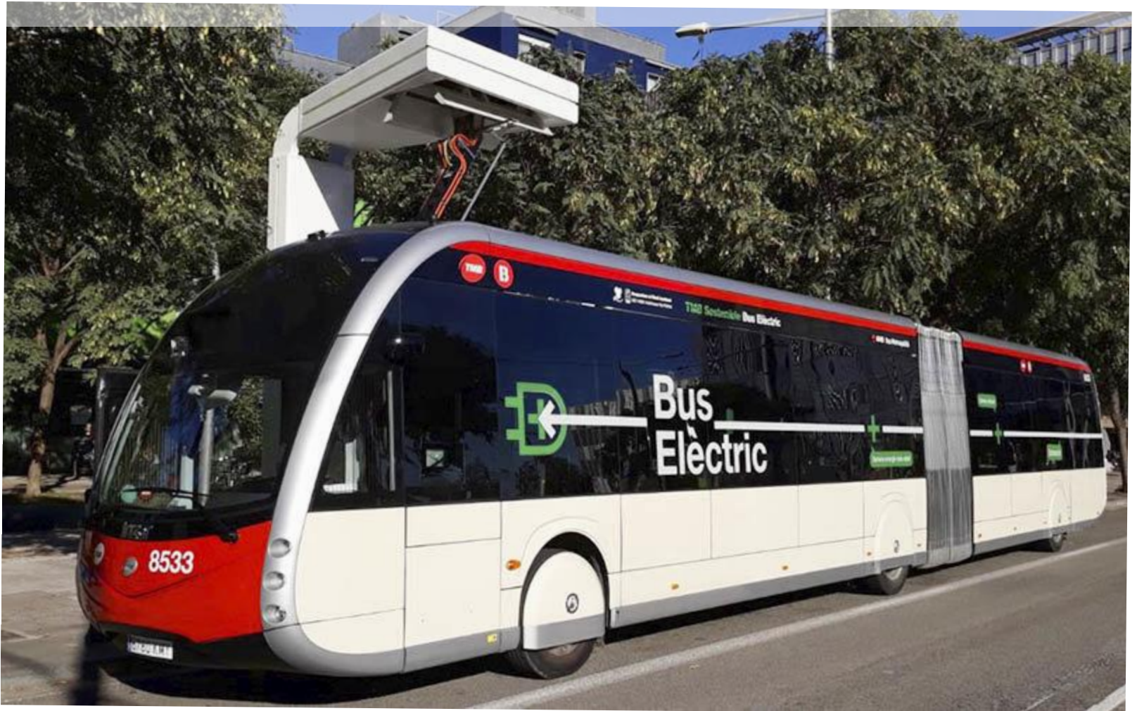
Fig. 8 Bus elettrico a batterie in ricarica "on the way"
